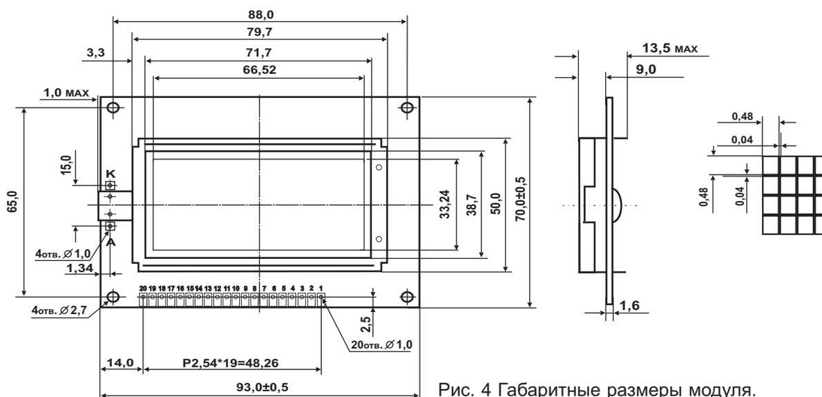
Рис. 4 Габаритные размеры модуля.
