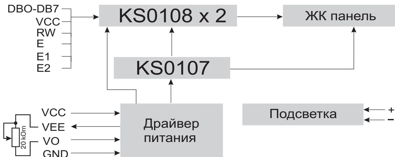
Примечание. Для модуля МТ12864А-5V драйвер питания отсутствует, вывод VEE не задействован.
